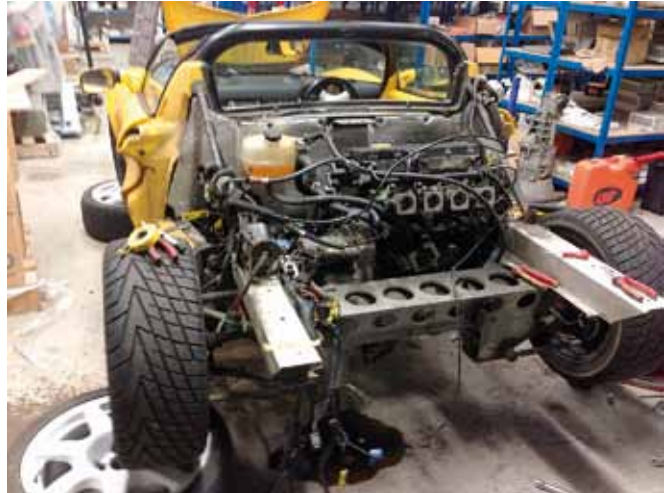
Stråvorna bakåt utgår inte från skyddsågens översta del.
