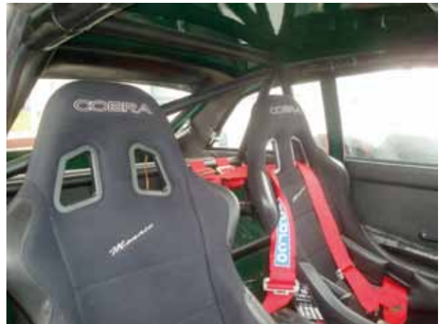
Bakre delen av cockpit. Notera den stabila skyddsburen samt 4-punktsbältet på förarplatsen.
