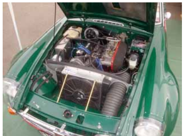
Ett prydligt motorrum med mycket Volvo: motor B23, kylare 242, bromssystem 242. På höger sida den kraftiga luftintagsslangen till de två Weber 48:orna.
